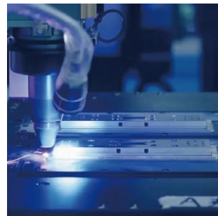
电池顶盖焊接
